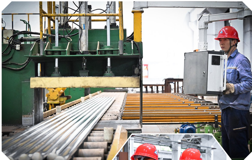
▲图为西南铝挤压线员工锯切铝棒材。 ►西南铝员工桥正铝型材。 李影 摄
