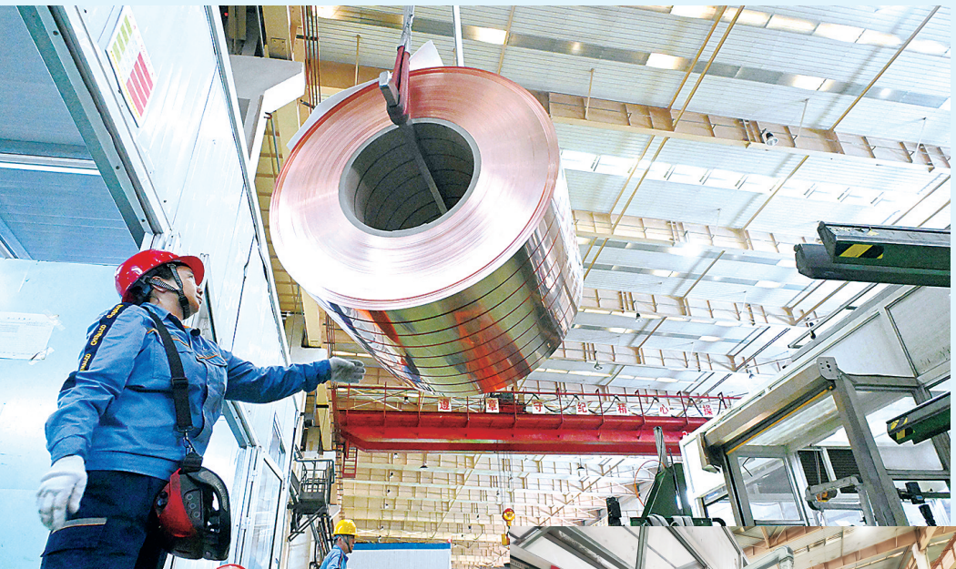
▲图为操作人员将新研制的高性能铜合金材料吊往下道工序。 ▶图为操作人员紧盯流程细节,确保新产品入库质量。 许利民 摄
