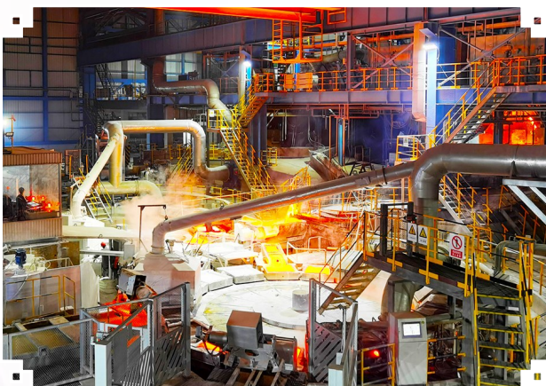
图为东南铜业阳极铜圆盘浇铸生产线。
